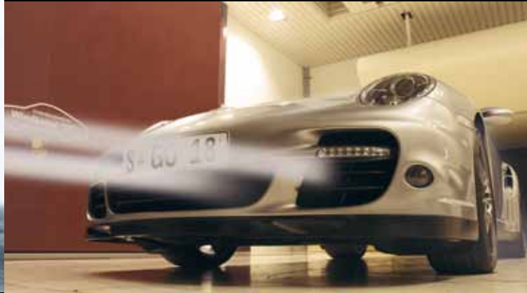
Im Lichttunnel wird die Lackierung geprüft.
