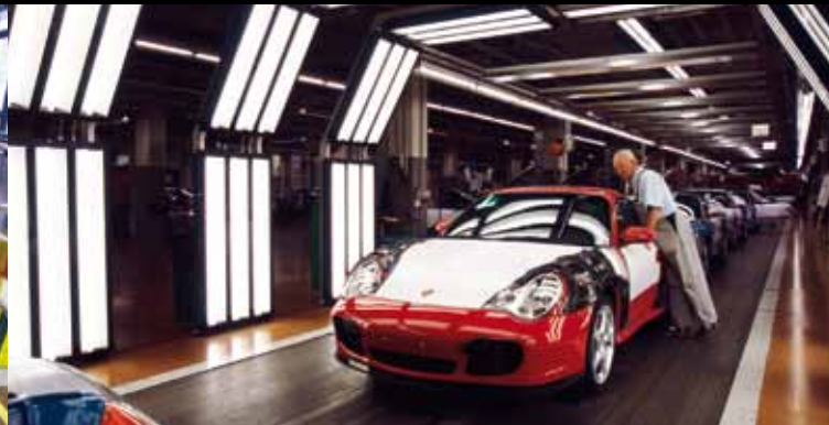
Im Lichttunnel wird die Lackierung geprüft.
